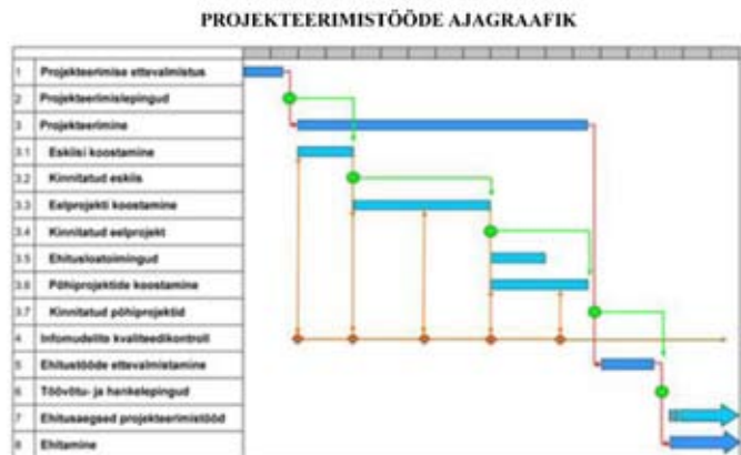
Joonis 2. Mudelprojekteerimise ajagraafik. Graafikut liigendavad tellija otsused ning mudelite integreerimine ja kvaliteedikontrollid. Mudelite kvaliteedikontroll jätkub ka ehitusstaadiumis.
