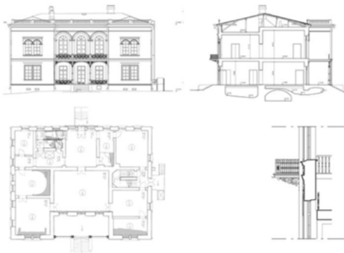
Joonis 10. Mõõdistusmudeli alusel loodud mõõdistusjoonised. Hakasalmi villa, Helsinki linn. Joonis: Tietoa Finland Oy.
