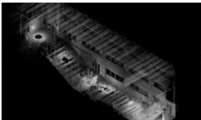
Joonis 7. Vasakul sisemõõdistamise ja paremal välismõõdistamise laserskaneerimise punktipilve mudel. Joonis: Tietoa Finland Oy.
