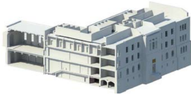
Joonis 4. Ehitise osade mudel koosneb standardosadest nagu seinad, plaadid, trepid, aknad ja ukсед. Euroopa Kool Soomes Helsinki. Senate Properties, ISS Suunnittelupalvelut Oy.
