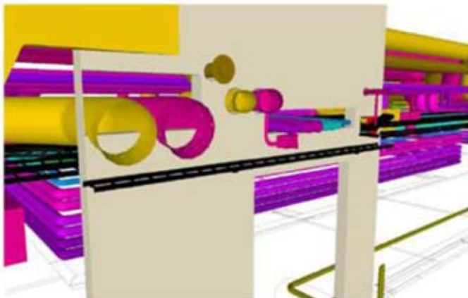
Joonis 5. Tehnosüsteemide mudeli ja konstruktiivse mudeli vastuolukontroll.
