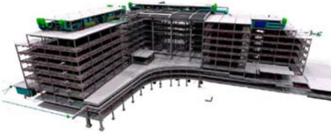
Joonis 2. Tehnosüsteemide projekteerija koostatud visualiseering, mille aluseks on hoone konstruktsioonide ja tehnosüsteemide mudelid. Tapiola peakontor; inseneribüroo Olof Granlund, konstruktiivne mudel Finnmap Consulting Oy.
