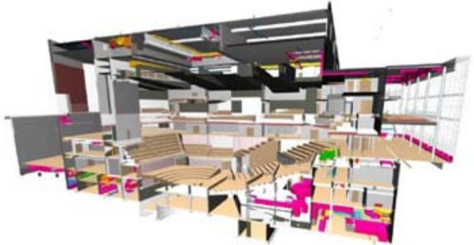
Joonis 8. Tehniline illustratsioon. Koondmudeli lõikel on näha tehnosüsteemide paiknemine tarindite suhtes. Värvitoonid ja pinnamaterjalid on sümboolsed ja neid on kasutatud projekti tehniliseks hindamiseks. Helsingi Muusikamaja, LPR-Arkkitehdit Oy, inseneribüroo Mikko Vahanen Oy, inseneribüroo Olof Granlund Oy, inseneribüroo Lausamo Oy, visualiseerija Gravicon Oy.
