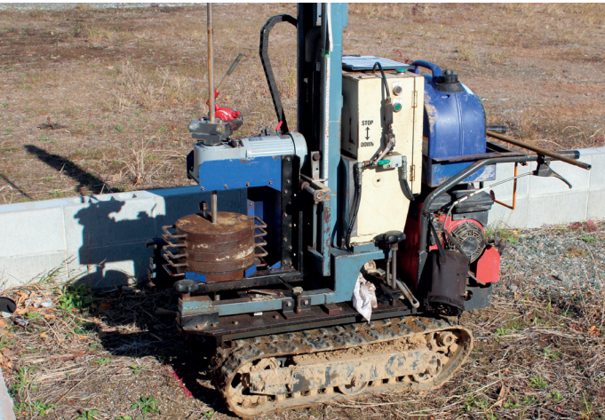
Väike mitmeotstarbeline puurimisseade. Roomikud aitavad liikuda pehmel maastikul ja muudavad masina stabiilsemaks. Masinal on surveseade survepuurimiste jaoks.
