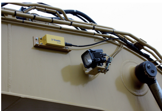
Suure ekskavaatori noole töövalgustid ja 3D-juhtüksuse lokalisaator (kollane karp)
