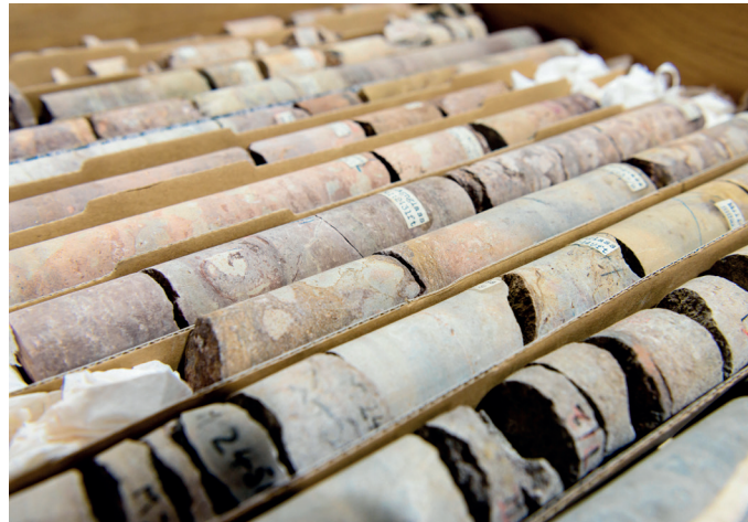
Lähtekivimi proovivõtmise materjal. Proovi alusel määratakse kivimi koostis ja tugevus.
