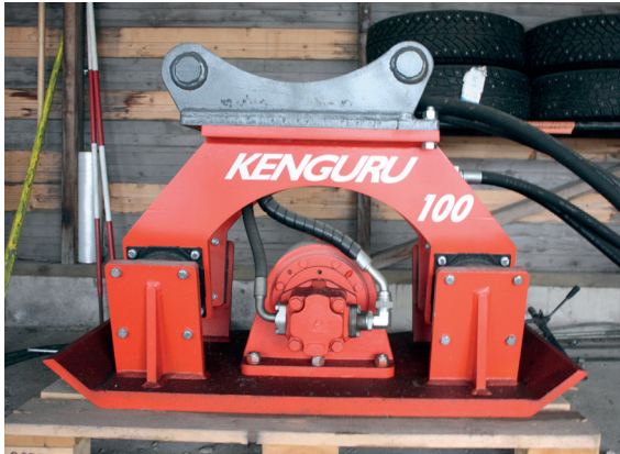
Vasakul on ekskavaatori külge kinnitatav hüdrauliliselt toimiv tihendusseade. Paremal on ekskavaatoriga ühendatav asfaldi lõikamiseks mõeldud lõiketera.
