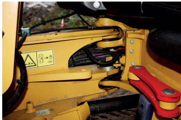
Suurema rataslaaduri liigendi ühenduskoht. Masina raam on kesktelt liigendiga, et liikumine oleks mitmekülgsem.
