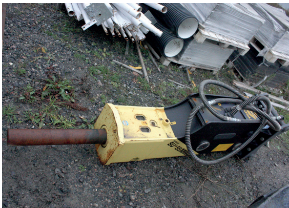
Vasakul on ekskavaatori hüdraulikaga ühendatav piik, mis toimib samal moel nagu piikimismasin. Paremal asuva kopa keeramis- ja kallutamismehhanism on samuti lisavarustus.
