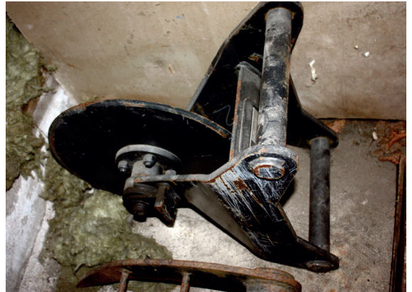
Vasakul on ekskavaatori külge kinnitatav hüdrauliliselt toimiv tihendusseade. Paremal on ekskavaatoriga ühendatav asfaldi lõikamiseks mõeldud lõiketera.
