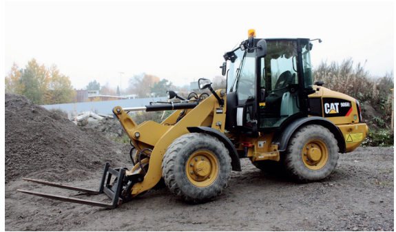
Suurem rataslaadur on tõhus ja kiire masin veokite laadimiseks. Selle võimsus lubab kasutada ka suuremaid koppasid. Pildil on tõstekahvel materjalide teisaldamiseks.
