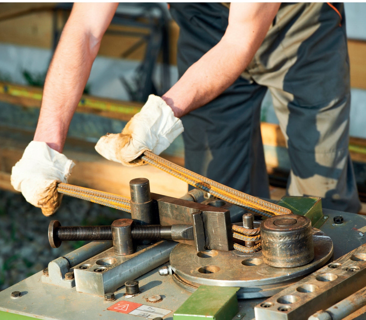
Armatuurterase painutaja. Armatuurteras ja konksud painutatakse painutuspingi abil õige nurga alla.
